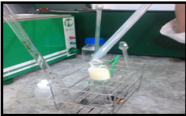
Figure 14: Ajouter 1 ml de lait à l'aide d'une pipette à l'acide sulfurique ( Benloucif .K )
