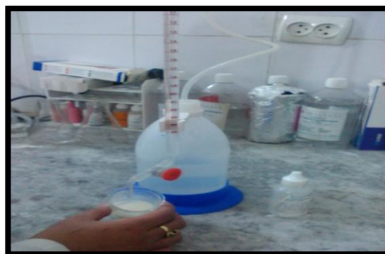
Figure 12 : Détermination de l'acidité titrable ( Benloucif .K )
