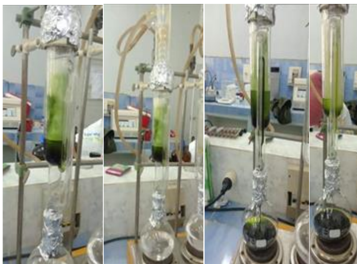
Figure II.5. Etapes de l'extraction par Soxhlet.
