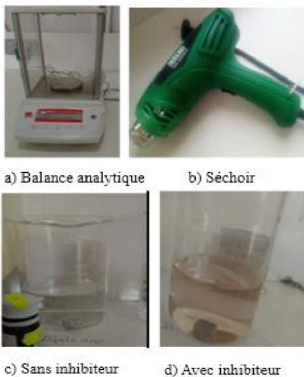
Figure.II.11. Matériels utilisés pour les essais de la perte de masse, a) Balance analytique, b) Séchoir, c) Sans inhibiteur, d) Avec inhibiteur.
