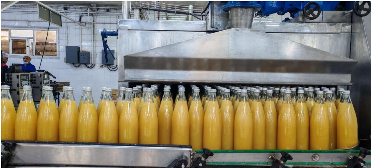
Figure .7. Remplissage des bouteilles de jus sur la chaîne de production ( Entreprise CARAJUS, 2026 ).
