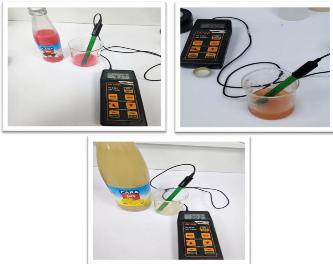
Figure. 04 .Mesure du pH des différents jus à l'aide d'un pH-mètre (Gaidi, 2026).
