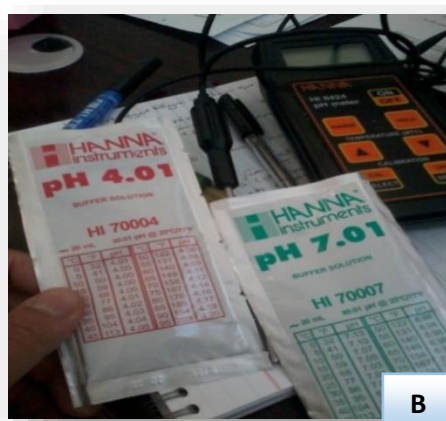
Photo 3 : pH-mètre (A) et solution d'étalonnage (B) utilisés pour la détermination du pH de lait cru (cliché personnelle).
