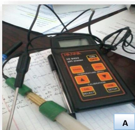
Photo 3 : pH-mètre (A) et solution d'étalonnage (B) utilisés pour la détermination du pH de lait cru (cliché personnelle).
