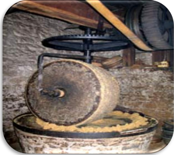
Figure10 : Anciennement, les triturateurs réalisaient l'extraction de l'huile de fruits et pépins à l'aide de meules:
