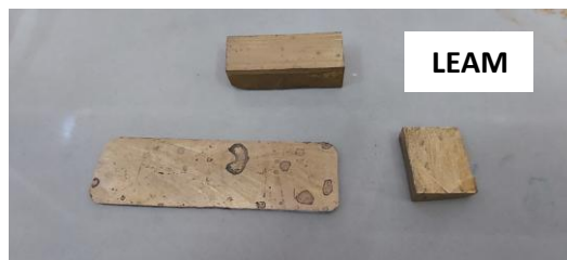
Figure 3.6 : Echantillons de CuZnAl à l'état brut
