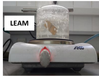
Figure 3.11 : Echantillon ayant subi un revenu à 100°C
