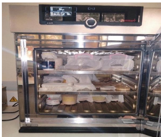
Photo 5. L'étuve sous conditions optimales : T 27C°, H 70%. (Bendada, 2020).
