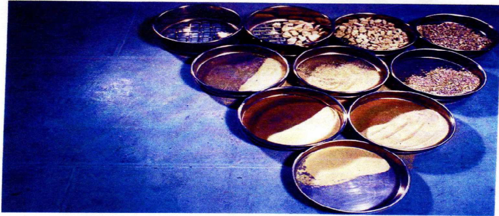
Photo06 : Refus dans les différents tamis
