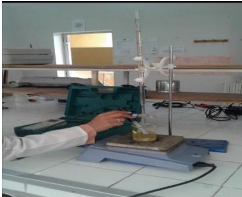
Figure 25 : Mesure de l'acidité libre d'échantillon jusqu'à le point d'équilibre.
