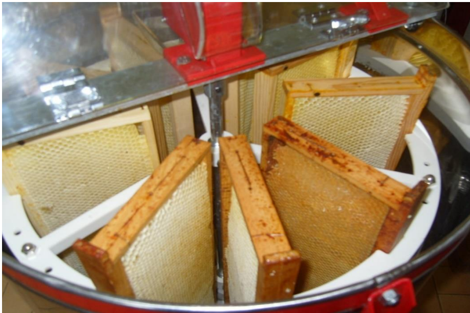
Figure 16 : Intérieur de la cuve d'un extracteur
