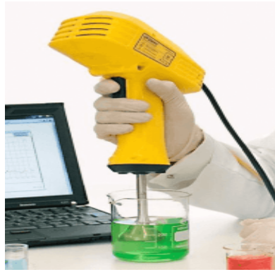
Figure 17 : Sonde à ultrasons.
