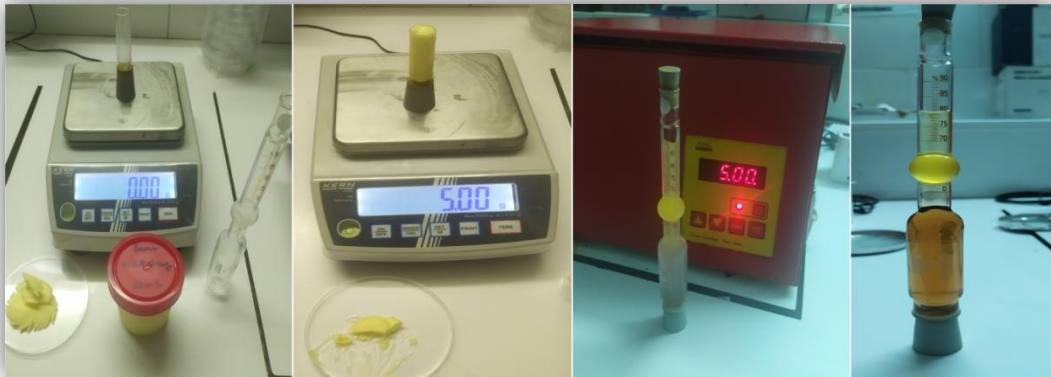
Figure 30. Détermination matière grasse du beurre (Attoui et Berredgem, 2021).
