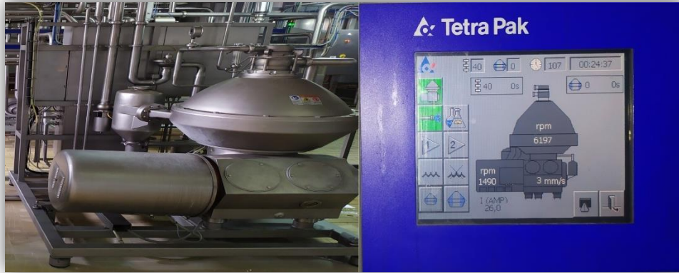
Figure 22. Séparateur crème avec ses paramètres (Attoui et Berredgem, 2021).
