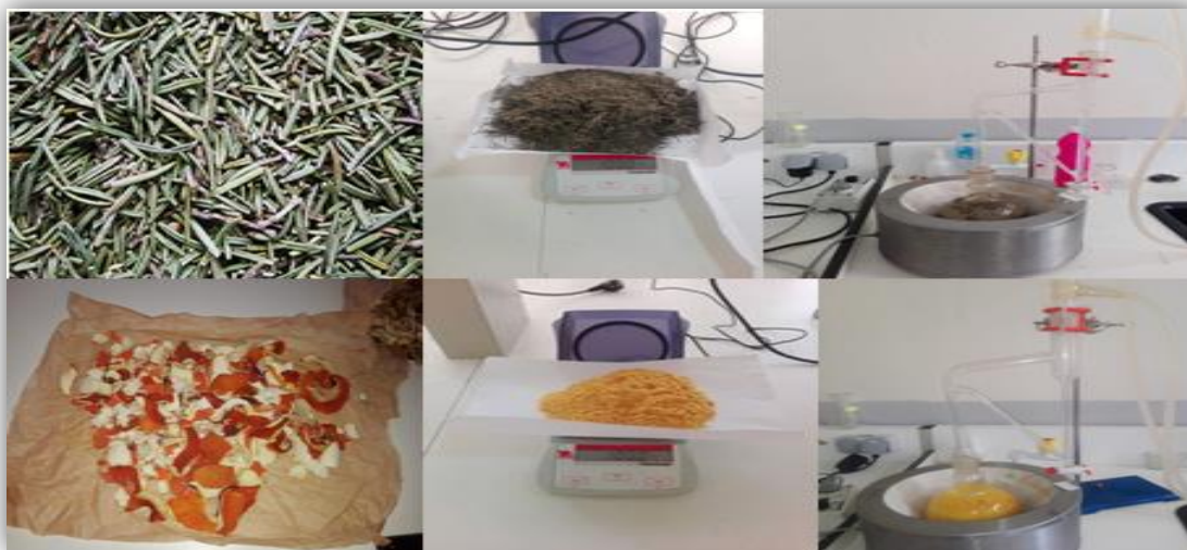
Figure 17. Extraction des huiles essentielles de romarin et d'orange (Atoui et Berredjem, 2021).
