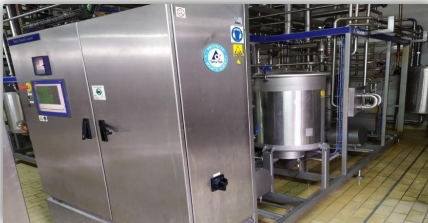
Figure 23. Pasteurisateur de crème (Attoui et Berredgem, 2021).
