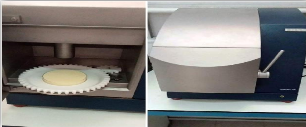
Figure 28. Détermination de la composition chimique à l'utilisation de Food Scan™ - FOSS ( Attoui et Berredjem, 2021 ).
