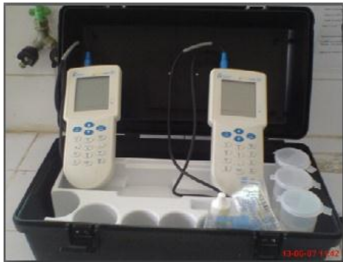
Figure 8 : Multi paramètre de terrain (Pionner 20 et Pionner 30)
