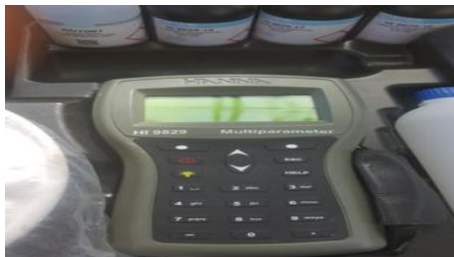
Figure18: Multi-paramètres HANNA, HI 9829 de terrain (Ramoul, 2022)
