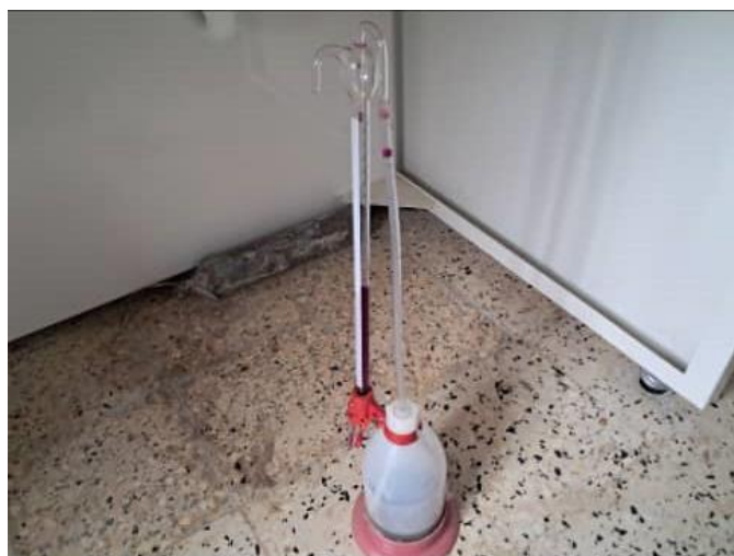
Figure 30: Titrage colorimétrique à l'acide sulfurique (Photo Hendi Fathi 2026)
