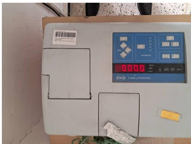
Figure 29: Turbidimètre « HACH 2100N » (Photo Hendi Fathi 2026)
