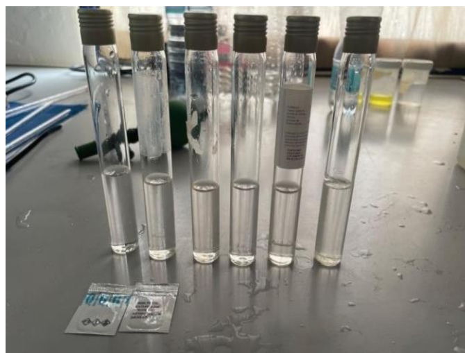
Figure 31: dosage colorimétrique du fer par la 1,10-phénanthroline [69]
