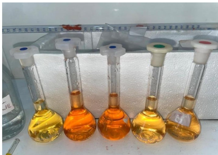
Figure 32: dosage de l'aluminium au rouge d'alizarine. [69]
