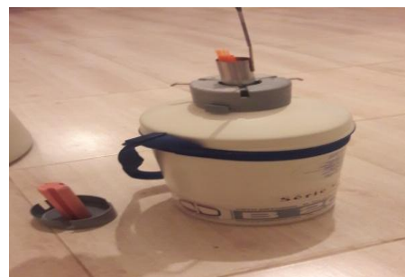
Figure 25 : réservoir de stockage (Cuve MVE)
