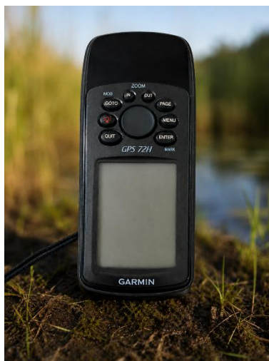
Figure 8. GPS portable Garmin GPS 72H utilisé pour le relevé des coordonnées géographiques des points de prélèvement.
