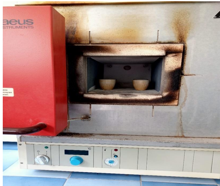
Figure 11 : Opération de calcination des échantillons (Salhi, 2026)
