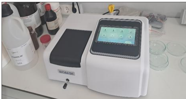
Figure 10. Spectrophotomètre BK-UV1600G/V1600G utilisé pour le dosage de l'ammonium (Photo personnelle, 2026).
