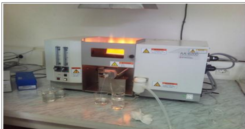
Figure 11. Spectromètre d'absorption atomique à flamme SHIMADZU AA-6200 ( Photo personnelle, 2026 ).
