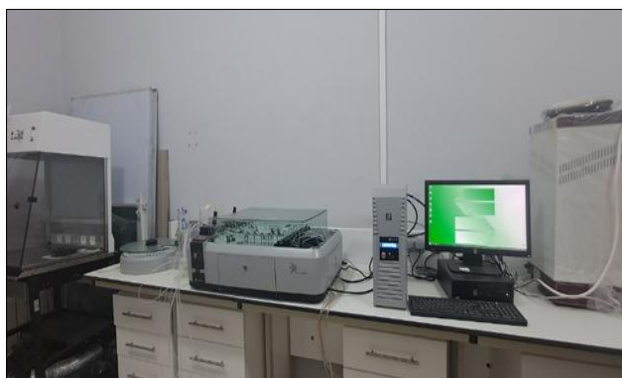
Figure 9. Auto-analyseur SAN++ System utilisé pour les analyses chimiques (Photo personnelle, 2026).
