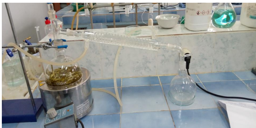
Figure 13. Extraction par hydro distillation (photo, Boudellal).
