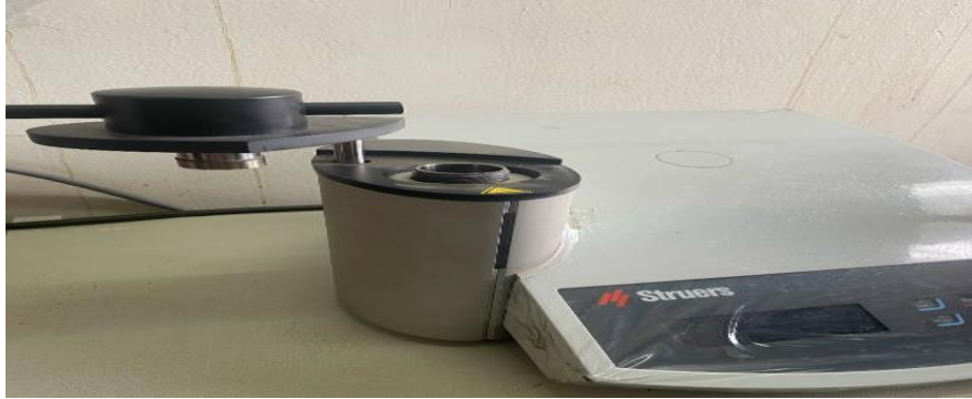
Figure (2.8) : L'échantillon enrobé à chaud par l'enrobeuse STRUERS
