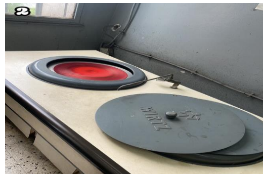
Figure (2.9) : Polissage de l'échantillon : 1-Prépolissage sur les papiers abrasifs 2-Finition sur une pate diamantée
