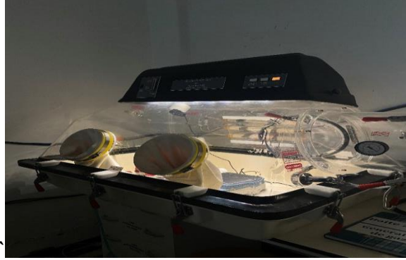
Figure (2.2) : Boite à gant type Plas-LabsInc, sous atmosphère d'argon.
