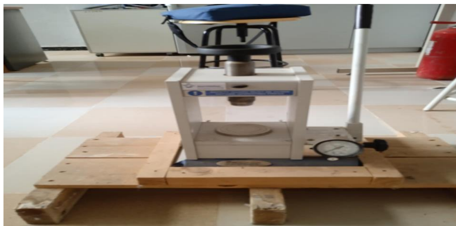
Figure (2.5) : Presse hydraulique uniaxiale de type SPECAC.
