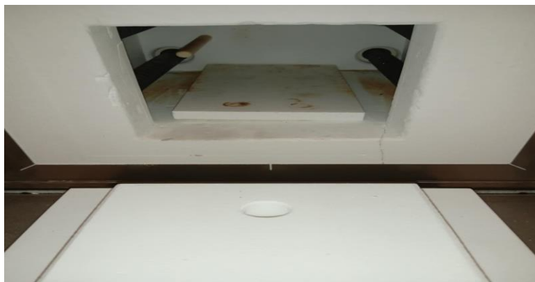
Figure (2.7) : Mise en place de l'échantillon dans l'enceinte du four.
