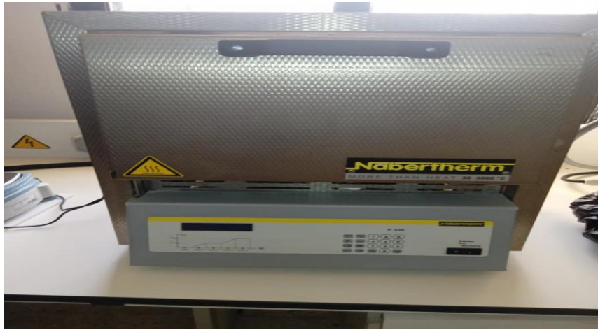
Figure (2.6) : Le four utilisé dans l'opération de frittage de la marque NABERTHERM.
