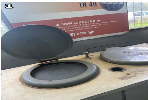
Figure (2.9) : Polissage de l'échantillon : 1-Prépolissage sur les papiers abrasifs 2-Finition sur une pate diamantée
