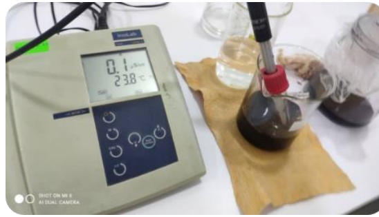
Figure 13. Mesure de la conductivité (Tlili, 2023)
