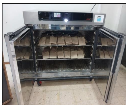
Figure 15: étuve utilisée pour le séchage des échantillons
