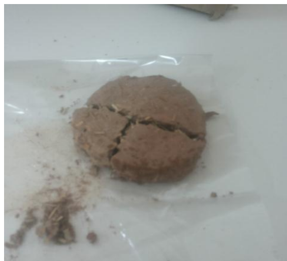
Fig.3.4. Le mélange après séchage (après 45 jours)
