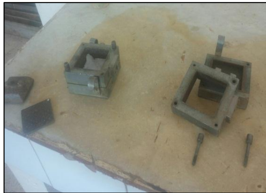
Fig. 4.1. Images réelle de la boîte de cisaillement.
