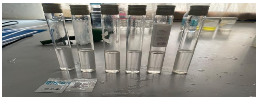
Figure 09 : dosage colorimétrique du fer par la 1,10-phénanthroline
