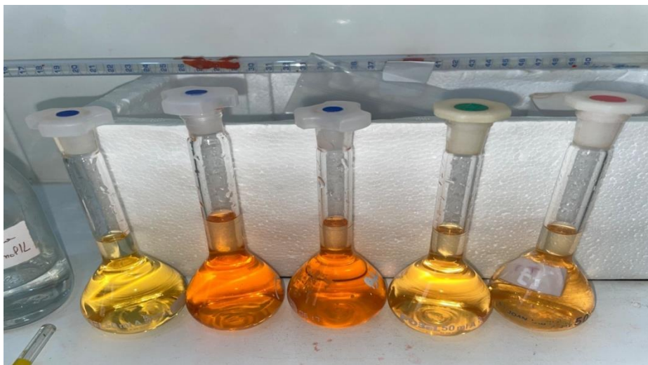
Figure 10 : dosage de l'aluminium au rouge d'alizarine.
