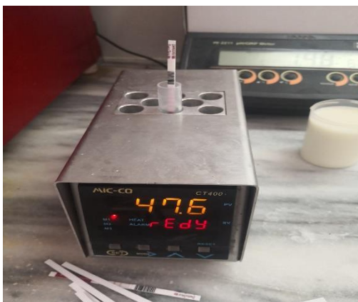
Figure N 8 : En haut à droite Lactoscan®, en haut à gauche un PH mètre, en bas à droite acidimètre, en bas à gauche Beta star® incubateur.
