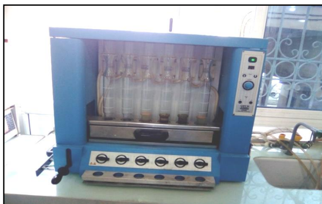
Figure 42. Appareil de dosage automatique Fibertec (VELP scientifica FIWE) (Photo personnelle, 2019).
