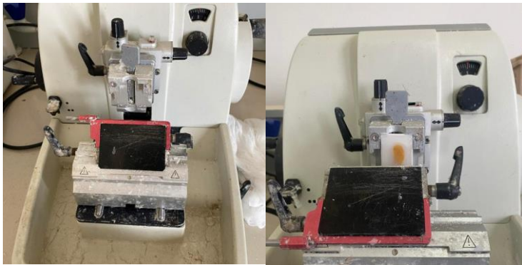
Figure 12 : un microtome et l'étape de l'étalement
