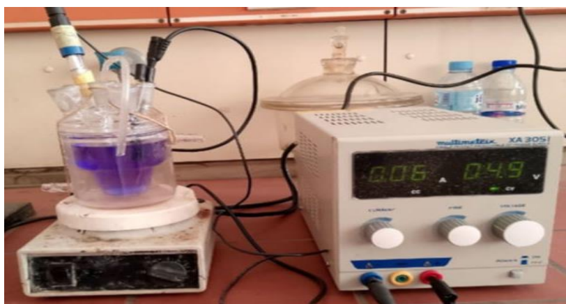
Figure III. 13: Montage expérimental de l'électrolyse à courant constant montrant la cellule contenant la solution de Crystal Violet (10 ppm, NaCl 1 M)
