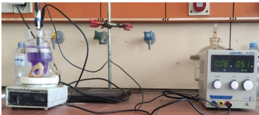
Figure II. 14 Montage expérimental de l'électrolyse à courant constant
