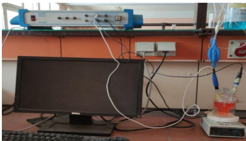
Figure III. 18: Montage expérimental utilisé pour l'électrocatalyse du Rouge Congo avec le \text{TiO}_2 synthétisé.
