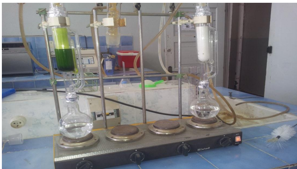
Photo 02: Soxhlet utilisé pour l'extraction de l'extrait méthanolique brut de plante (Badi Y, 2022).
