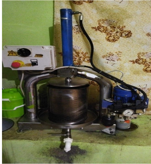
Figure 10 : Machine hydraulique électrique pour l'extraction des huiles.
