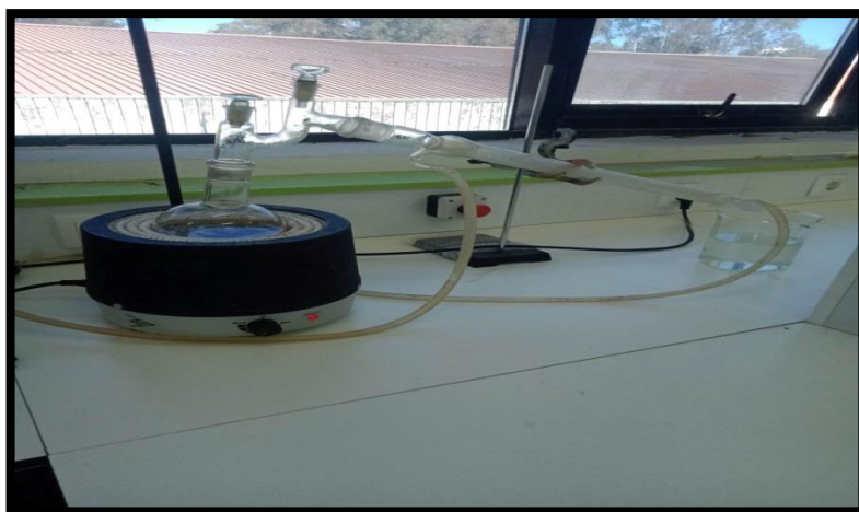
Photo III.2 : Dispositif d'Extraction par hydrodistillation (ABIDI Maroua 2023).
