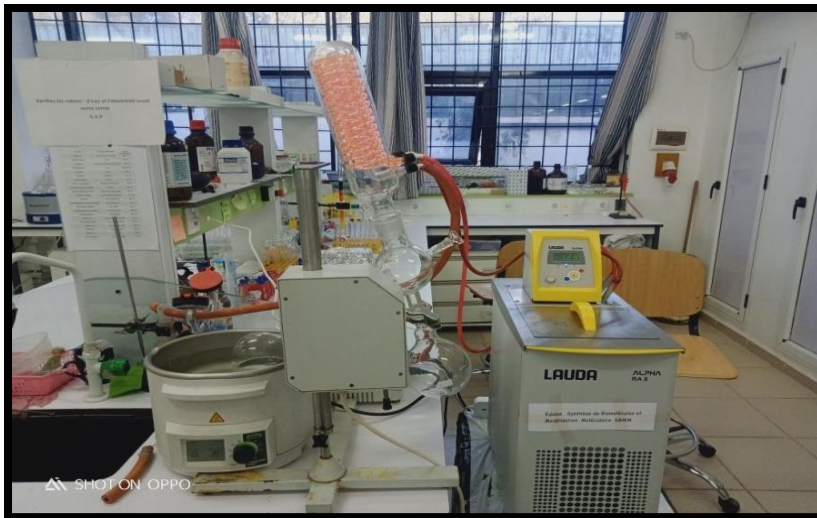
Photo III.6 : Montage d'évaporation (ABIDI Maroua 2023).
