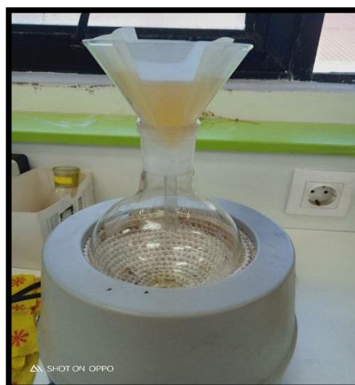
Photo III.5 : Filtration simple de la phase organique (ABIDI Maroua 2023)
