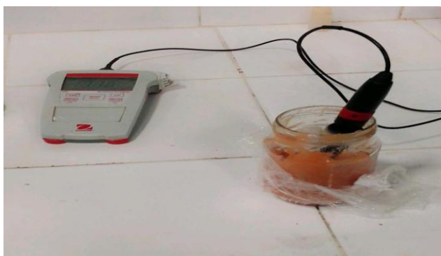
Figure 16: Mesure de pH des échantillons de confiture élaborés.
