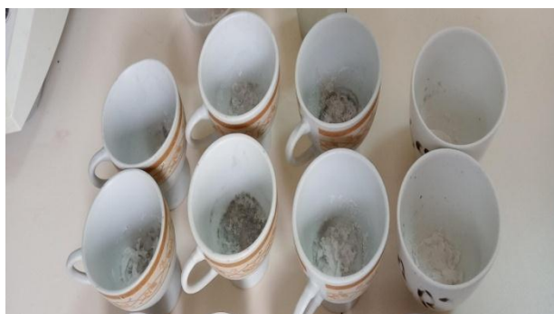
Figure 18 : Échantillons de confiture après calcination pendant 5h au four.
