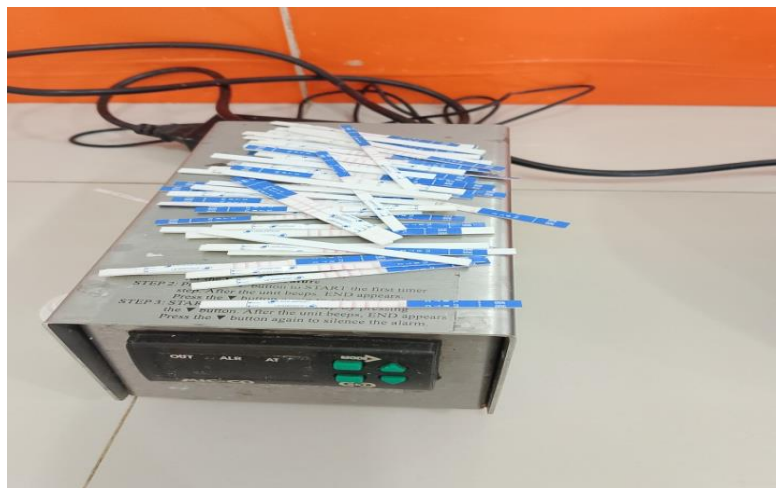
Figure11. Appareil rosa incubateur et les bandelettes (Photo personnelle).
