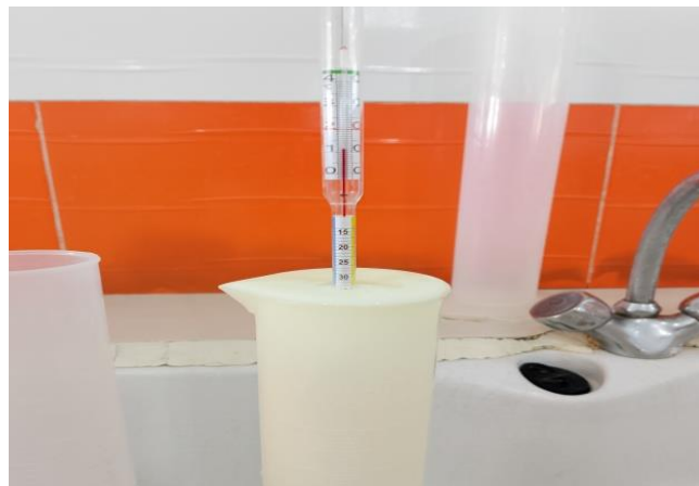
Figure 9. Le thermo-lactodensimètre (Photo personnelle).
