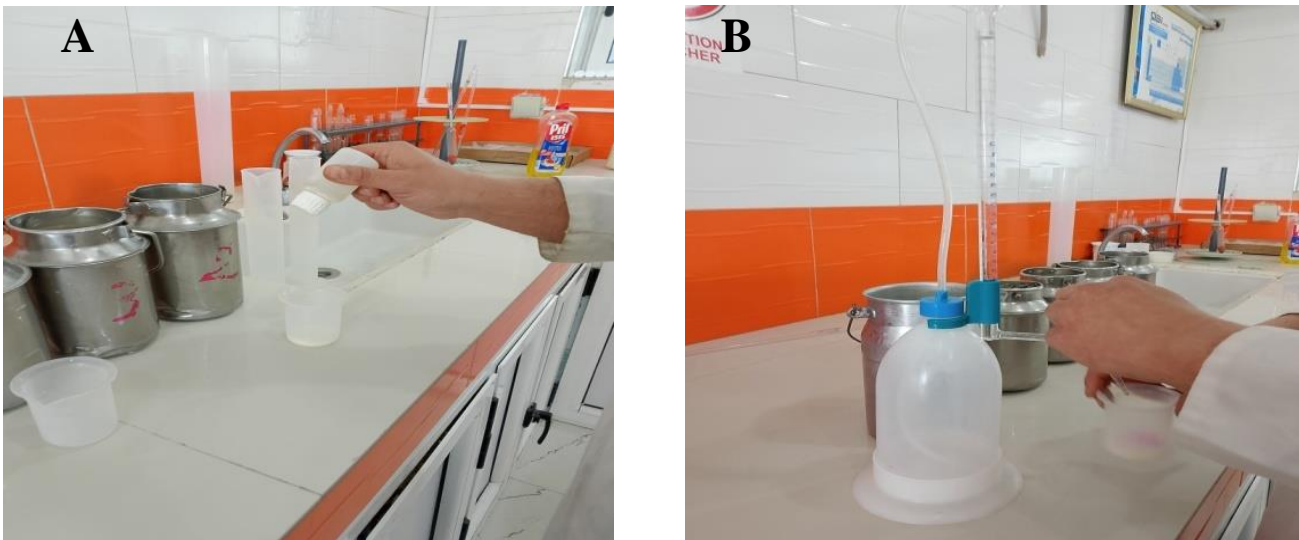
Figure 8. Technique de la mesure de l'acidité (A) laphénophtaléine, (B) la solution de NAOH (Photo personnelle).
