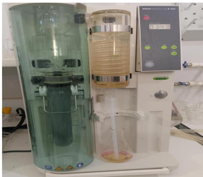
Figure 06 : Unité de distillation Kjeldahl (BÜCHI K-350) (Benarfa, 2026).
