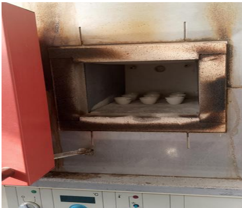
Figure 05 : Incinération des échantillons d'Acacia à 550 °C
