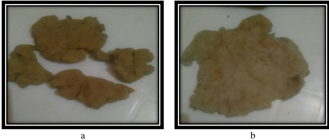
Figure III. 2 : L'argile après séchage (après 4 jours) : a) L'argile marron, b) L'argile blanche .
