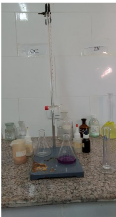
Figure 17: a) Couleur violet avant l'étalonnage b) Titrée avec l'EDTA (Bouhafara, 2025).
