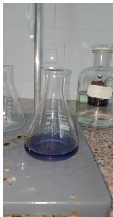
Figure 17: a) Couleur violet avant l'étalonnage b) Titrée avec l'EDTA (Bouhafara, 2025).
