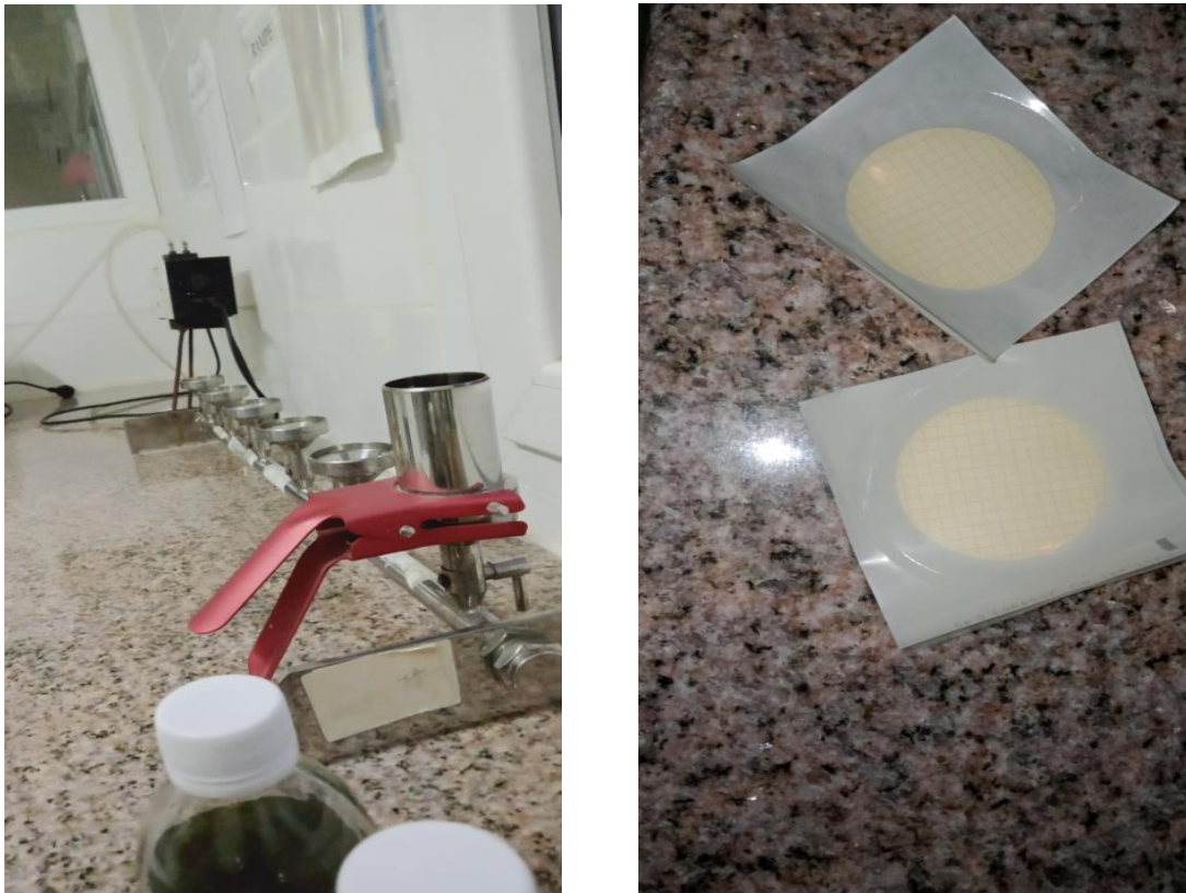
Figure 20: a) la Rompe de filtration b) les Filtres de 0.45 µm (Bouhafara, 2025).
