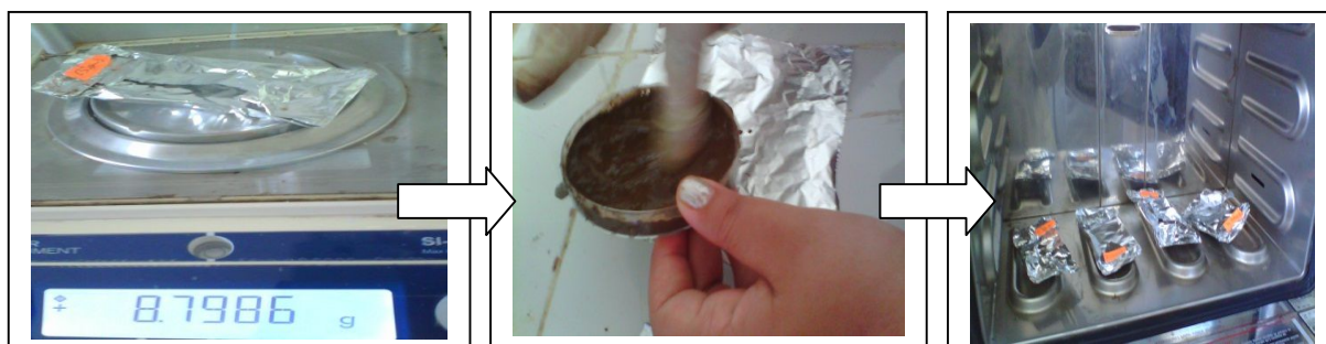
Photo n° 02 : détermination de la texture (Keblouti et Bounouar ,2016)
