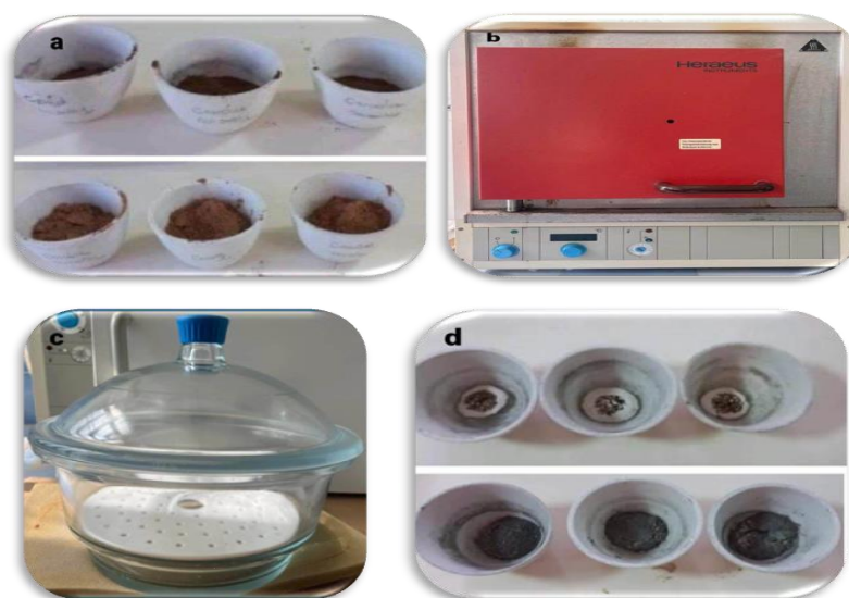
Figure 11. Détermination de la Teneur en cendres et en matière organique a) poudres végétales, b) Four à moufle, c) Dessiccateur, d) les cendres (Bouhaik, 2023).
