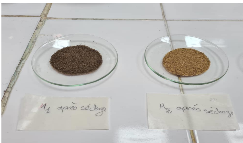
Figure II.3: Préparation du matériau adsorbant des pelures de fèves (PF) M2 et le matériau adsorbant des pelures de petits pois (PPP) M1
