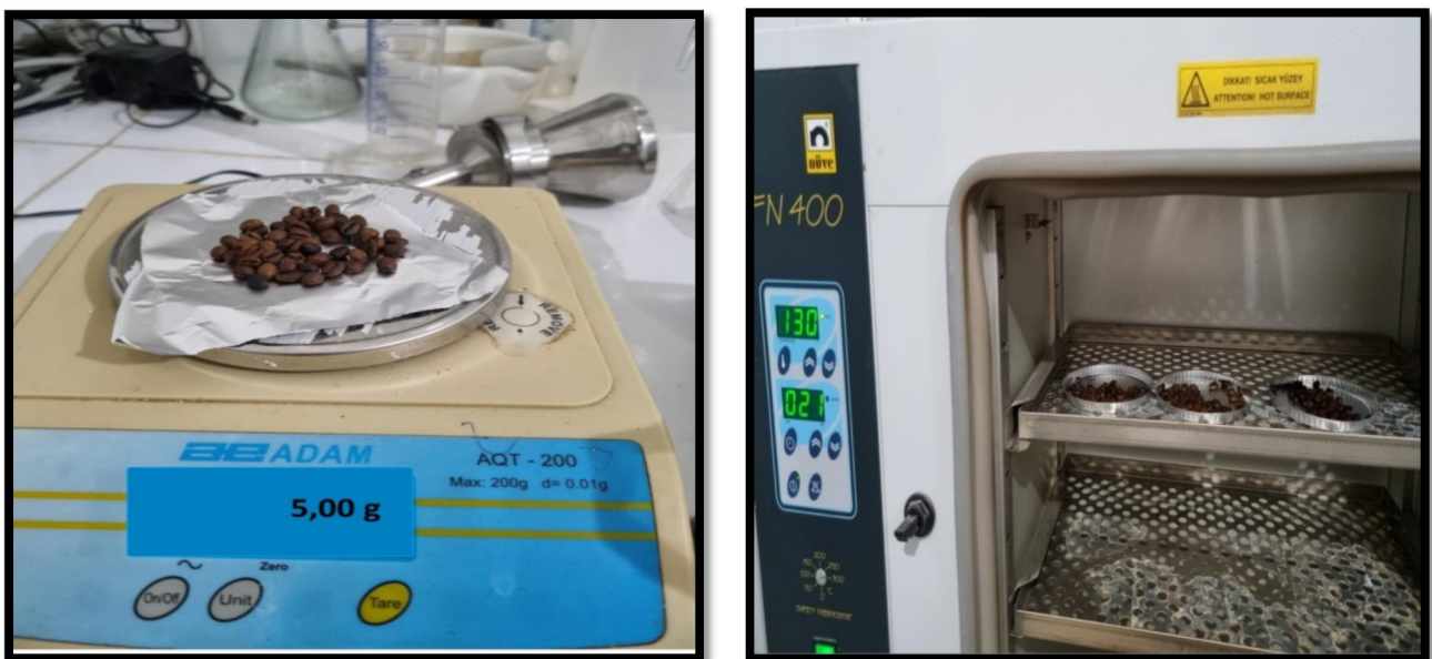
Figure .8. Peser 5 g de café sur une balance et Sécher dans une étuve (Ayat, 2025).
