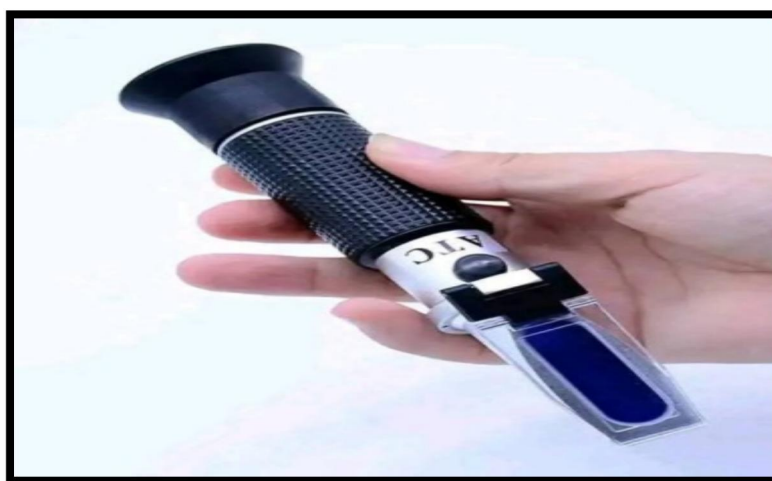
Figure .12. Mesurer les sucres solubles par réfractométrie (Ayat, 2025).
