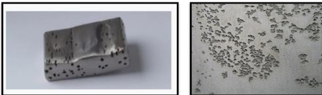
Figure I.4. Corrosion par piqûres
