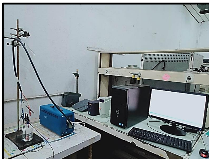
Figure II.12. Chaîne de corrosion
