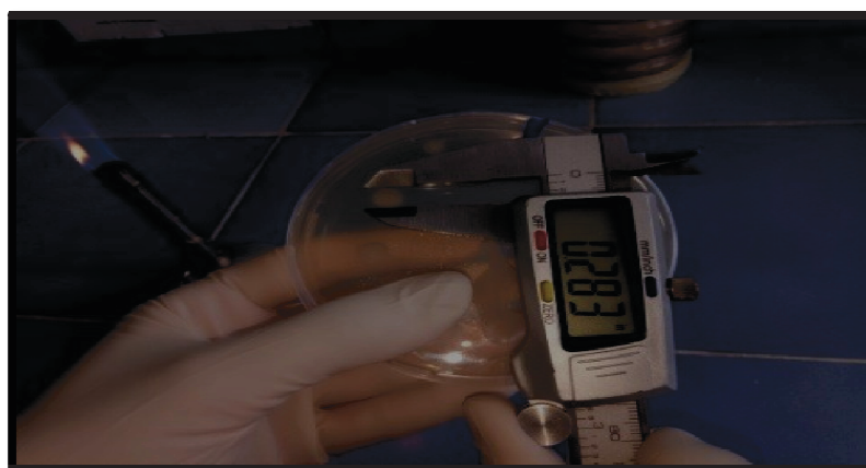
Figure N°19: Calcule des diamètres d'inhibition à l'aide de Pied à coulisse (Bennacer K, Zaamouni S, 2019)
