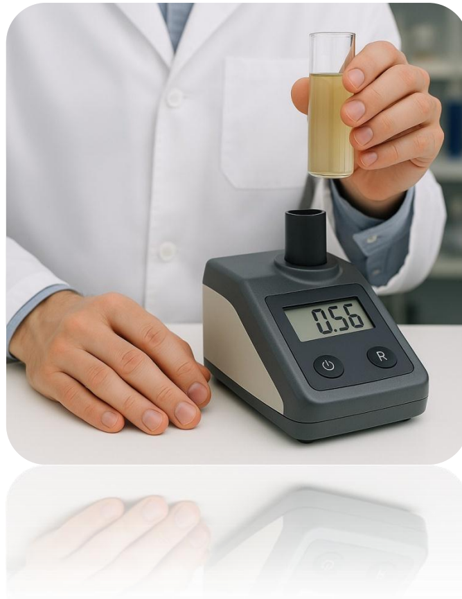
Figure 27 : L'évaluation de la turbidité d'eau (Turbidimètre).
