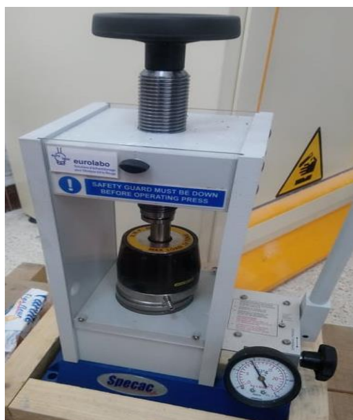
Figure II. 2: Presse hydrostatique utilisée pour la préparation des pastilles
