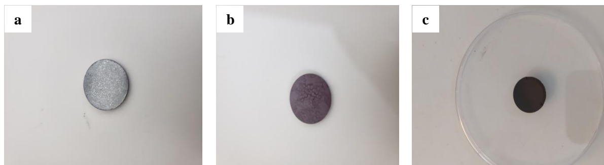
Figure II. 3: Pastilles cylindriques après pressage uniaxial : (a) \text{FeSb}_2 ; (b) \text{FeP}_2 ; (c) \text{FeSn}_2 .
