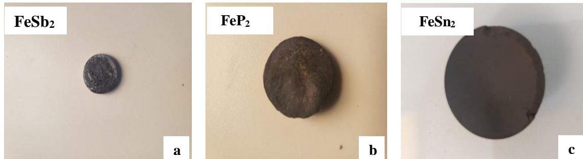
Figure II. 6 : pastilles frittées à différents températures (a) 700°C (b) 750°C et (c) 500°C
