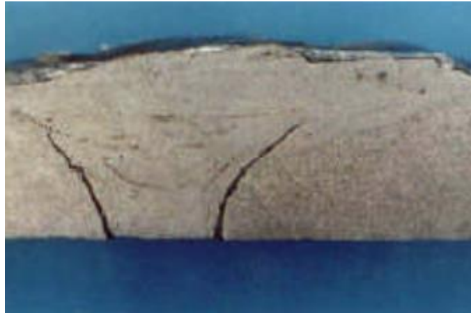
Figure I.15 : Fissure à froid. [7-8]
