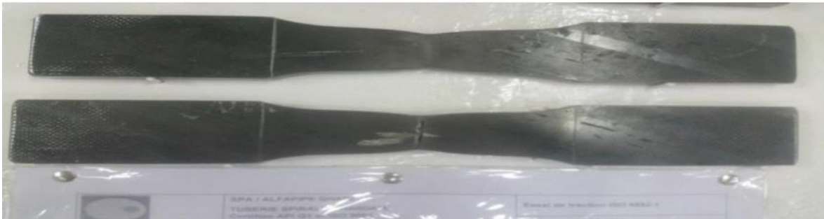
Figure IV.3: Traction de métal de base
