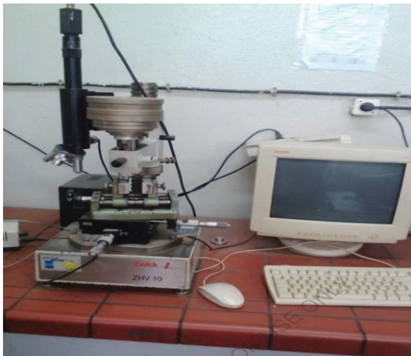
Figure II. 21 : Principe de la mesure de dureté par la méthode Vickers
