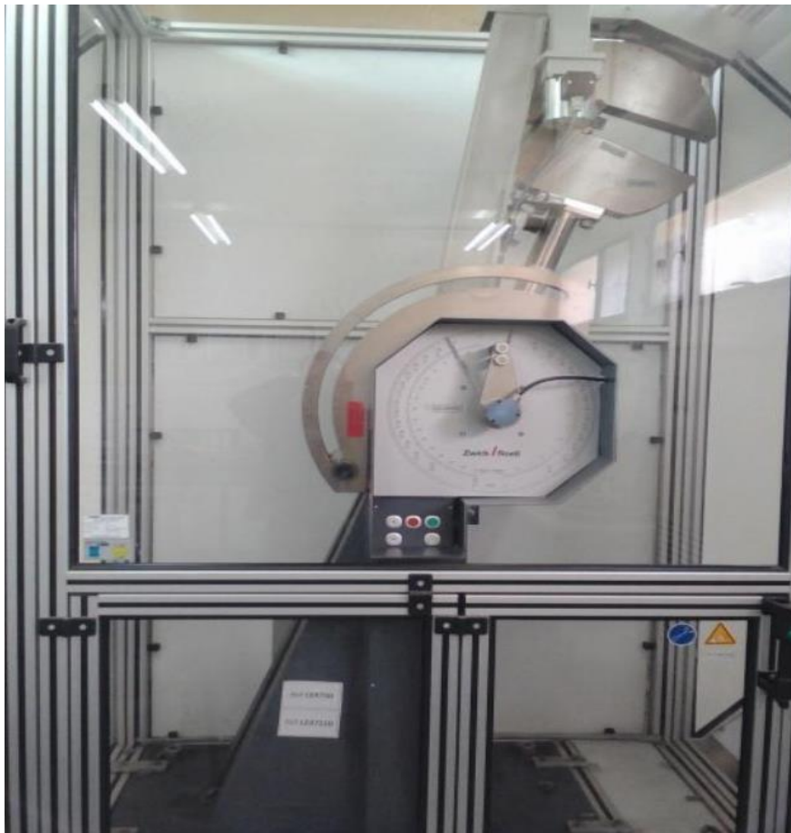
Figure III.17 : Machine de résilience universelle de type PSW750 ZWICK/ROELL
