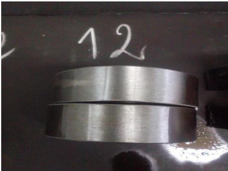
Figure IV.6 : Eprouvettes de pliage ED et EV après l'essai
