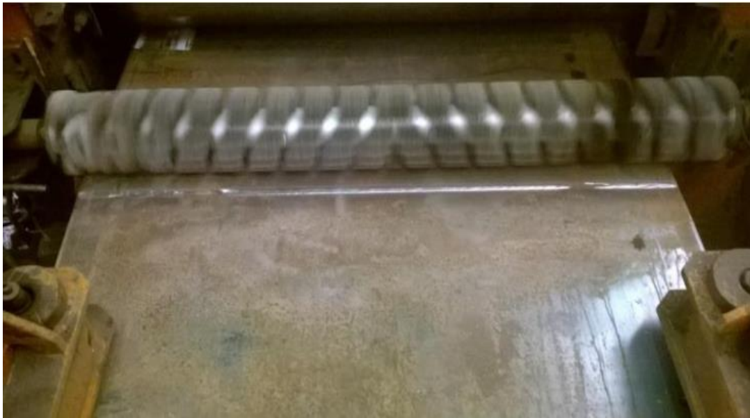
Figure I.5 : Le rabotage par Soudage automatique
