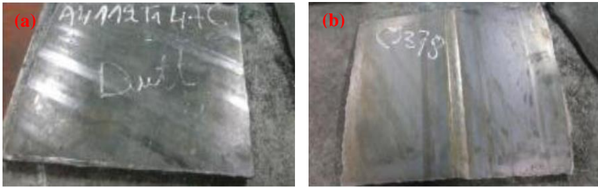
Figure III.3 : (a) Plaque "1" totalement en métal de base (b) Plaque "2" contenant le cordon de soudure.
