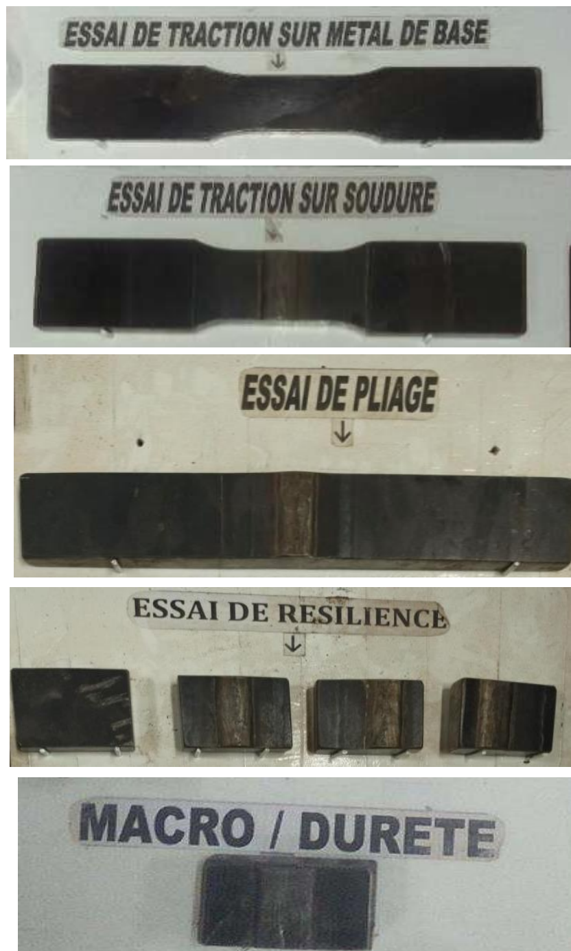
Figure III.7 : Les éprouvettes usinées par la fraiseuse
