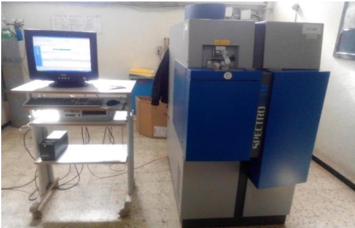
Figure III.8 : Spectromètre à étincelle de type SECTROLAB
