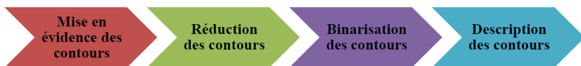
Figure 1.6 : Processus classique de détection de contours. [1]
