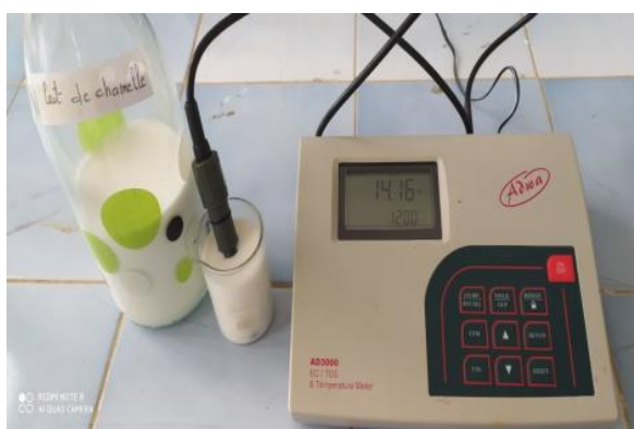
Photo III.3 : Conductimètre (REMADNI Mouchira 2022)
