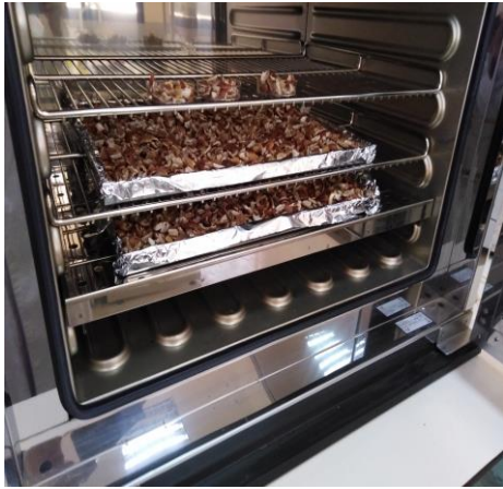
Figure 8 : le séchage dans l'étuve à 75°C (Aouine H 2019)
