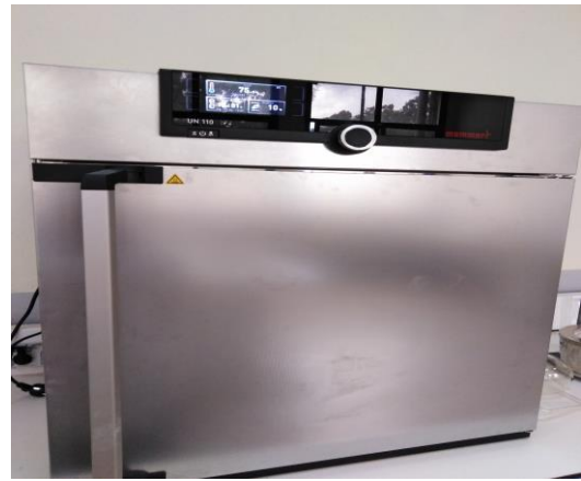
Figure 8 : le séchage dans l'étuve à 75°C (Aouine H 2019)
