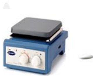
Figure 10 : Agitateur magnétique et barreau aimanté (CHELOUFI Sabrina 2024)
