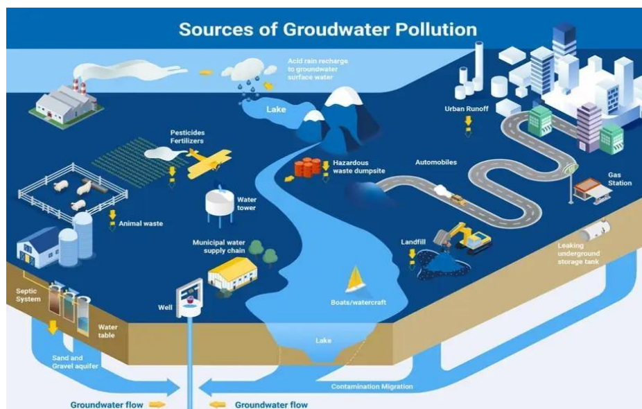
Figure I-2 : Diagramme conceptuel des différentes sources et voies de contamination des eaux souterraines [23].
